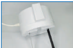
Крышка В крышку вмонтированы Темный электрод (анод) и Светлый электрод (катод)
